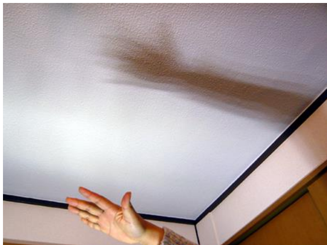
Obr. 17 Znatelný několikanásobný stín při osvětlení LED panelem při malé vzdálenosti od zdroje
