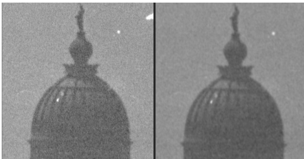
Obr. 4.8: Obraz naskenován suchou cestou (vlevo) a mokrou cestou (vpravo), oba rozlišením 4800 ppi. (Vitale, 2007, str. 23)
