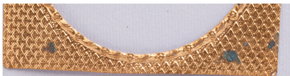
obr. 99 mosazná pasparta napadená měděnkou
