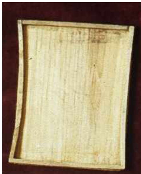
obr. 53 deformace dřevěné bočnice
