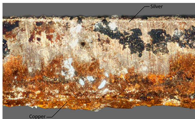
obr. 43 řez daguerrotypickou deskou; (silver – stříbro, copper - měď)
