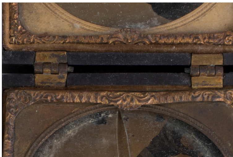
obr. 61 odřenininy mosaznýcg klavírních pantů
