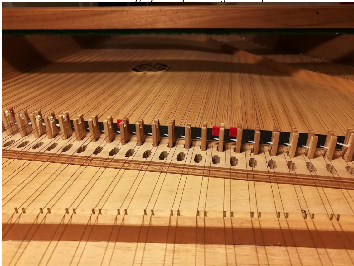
Instalace dusítek, trsací sloupky připravené před finální intonací
