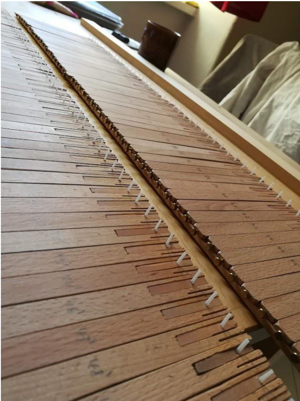
Osazení sloupků delrinem před hrubou intonací
