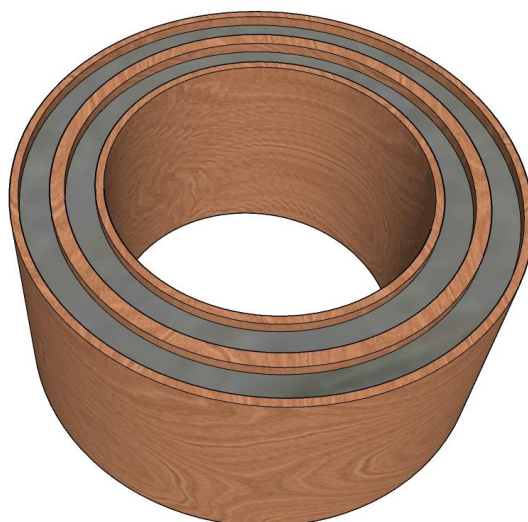
Obr. 22 Prostorové znázornění výroby bednění/formy
