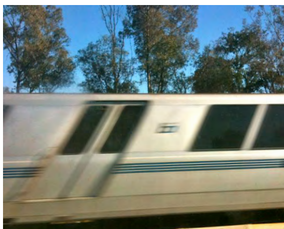
Obr. 25: Výsledný obraz objektu v pohybu zachycený rolovací závěrkou
