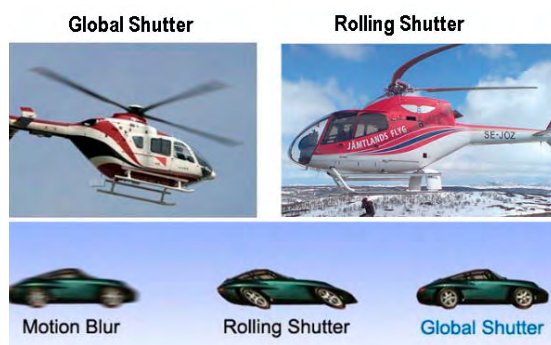
Obr. 26: Rozdíl mezi rolovací a globální závěrkou 1
