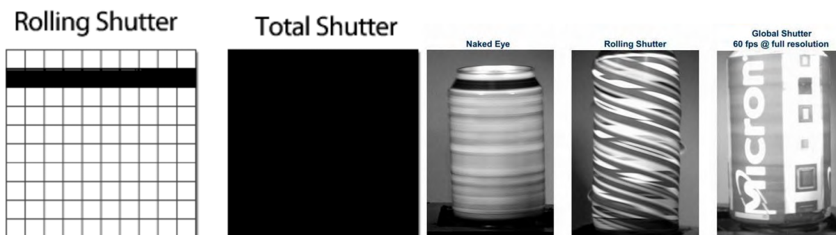
Obr. 28: Schéma rozdílu rolovací a globální závěrky
