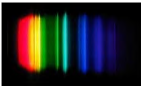
Čárové spektrum vysokotlaké sodíkové výbojky: Modré a zelené proužky jsou emisní čáry rtuť, červené a oranžové pásy jsou emise sodíku.
