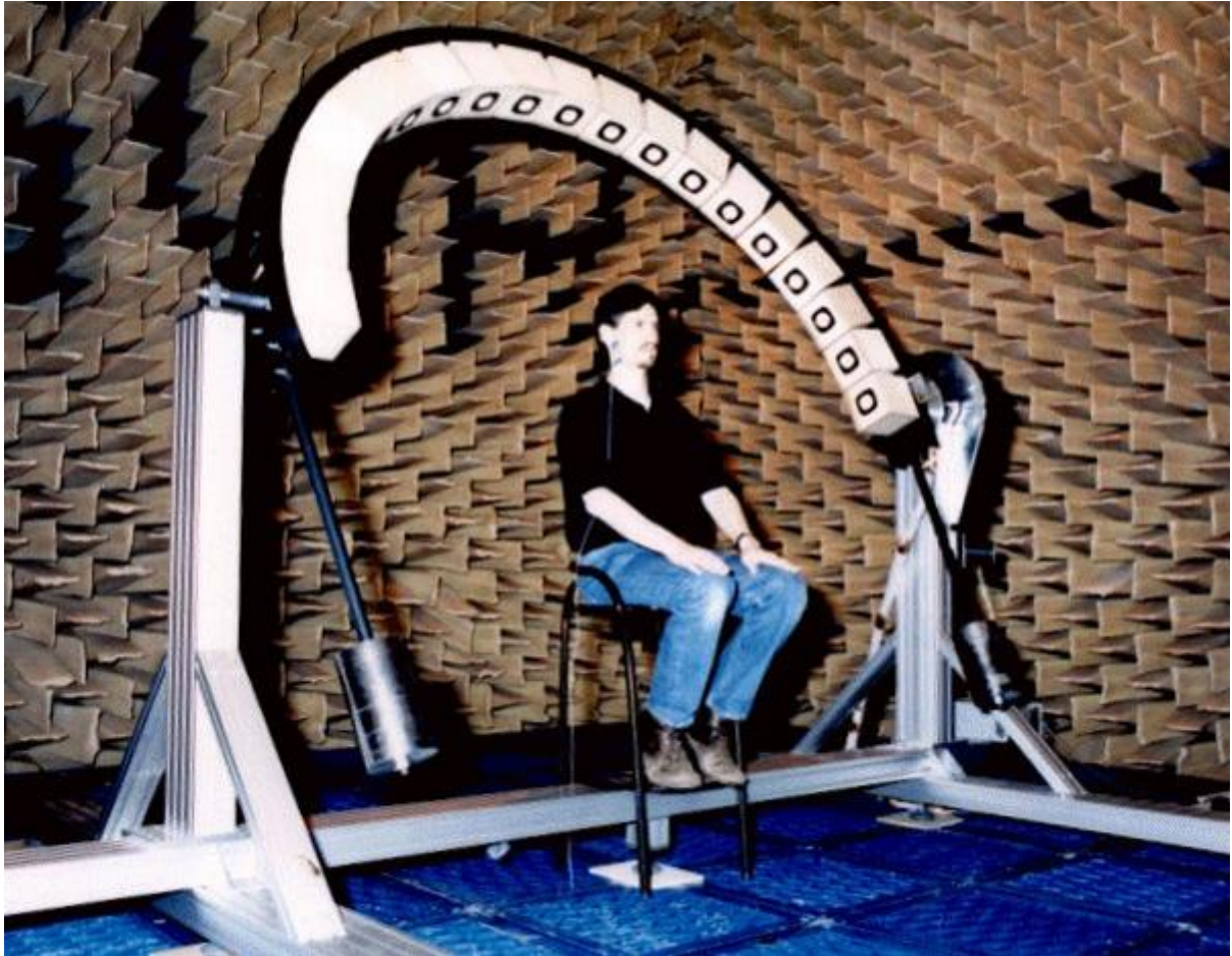
Obrázek 5 - měření HRTF v bezdozvukové komoře
