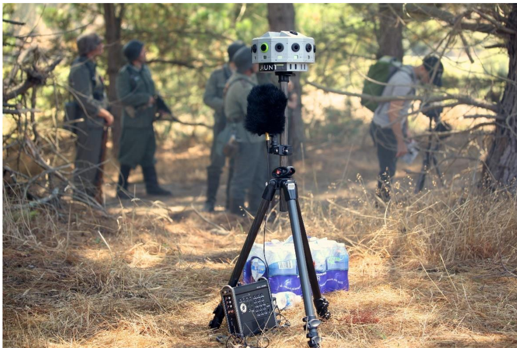
Obrázek 6 - Kamerový rig s ambisonickým mikrofonem a rekordérem
