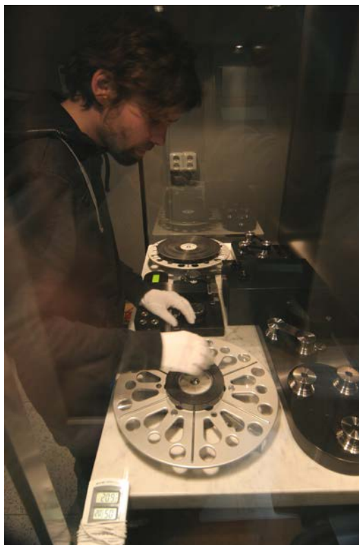
Obrázek č. 58: Optická dráha skeneru Nortlight 1 v Cinepostu odshora od trilineárního senzoru: shora světlovod, MSO filtr, metalhalogenidová výbojka, zrcadlo (VLEVO) – skenerista zakládá film do skeneru s horizontálním uložením (VPRAVO). [zdroj: Miloslav Novák, 2015]
