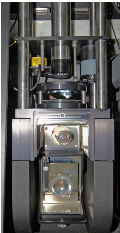
Obrázek č. 58: Optická dráha skeneru Nortlight 1 v Cinepostu odshora od trilineárního senzoru: shora světlovod, MSO filtr, metalhalogenidová výbojka, zrcadlo (VLEVO) – skenerista zakládá film do skeneru s horizontálním uložením (VPRAVO). [zdroj: Miloslav Novák, 2015]
