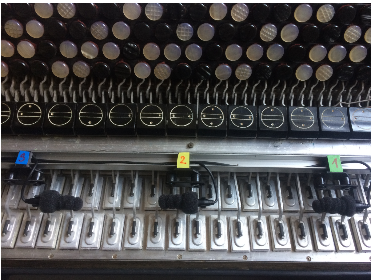
Obr. 32 Nové úchyty a molitanové návleky na diskantové části nástroje
