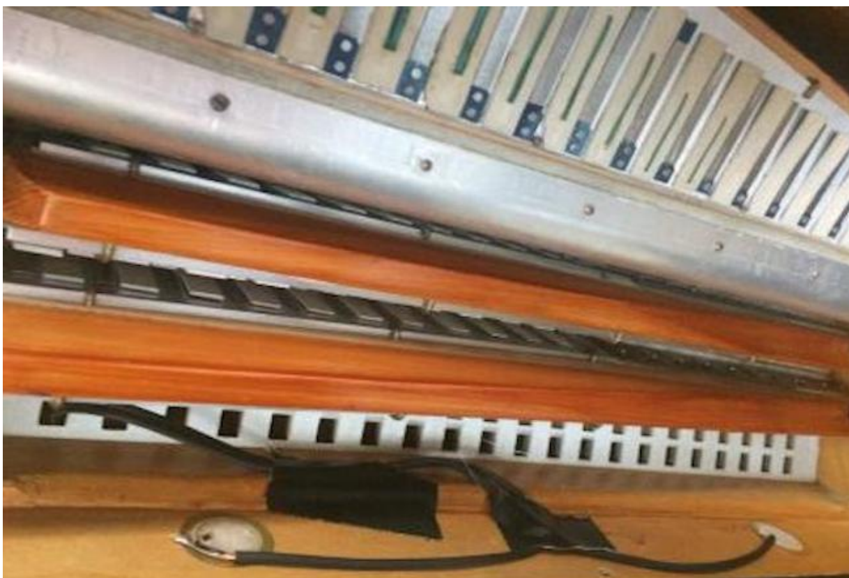
Obr. 4 Umístění piezoelektrických snímačů uvnitř diskantové části nástroje, fotografie
