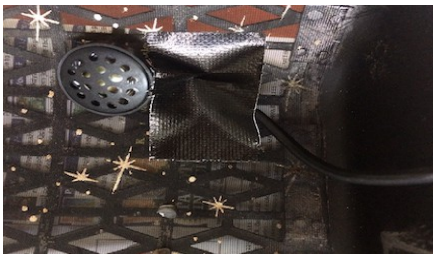
Obr. 5 Větší dynamické sluchátko na krytu diskantové části, fotografie
