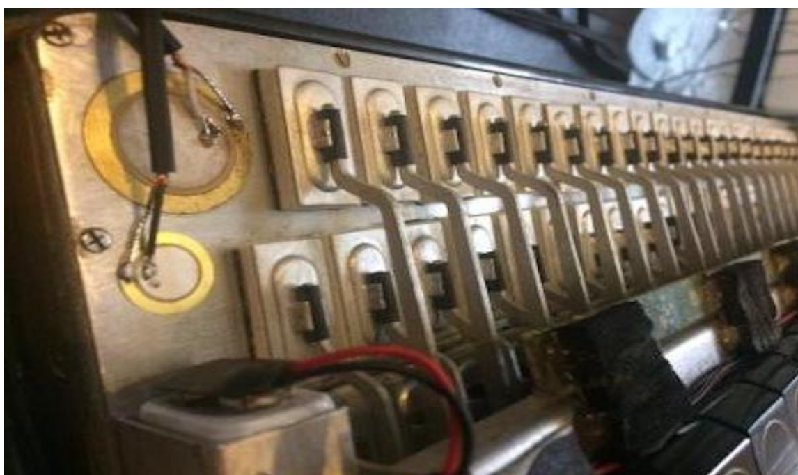
Obr. 2 Umístění piezoelektrických snímačů na diskantové části akordeonu, fotografie.
