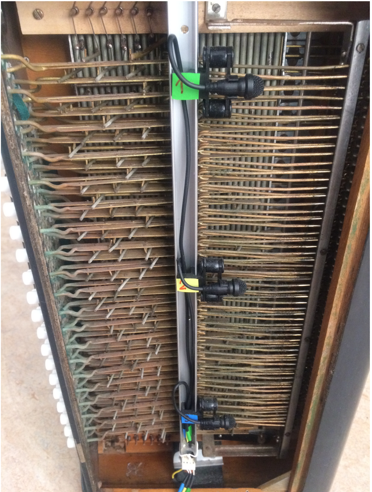
Obr. 31 Mikrofonní systém na basové části nástroje
