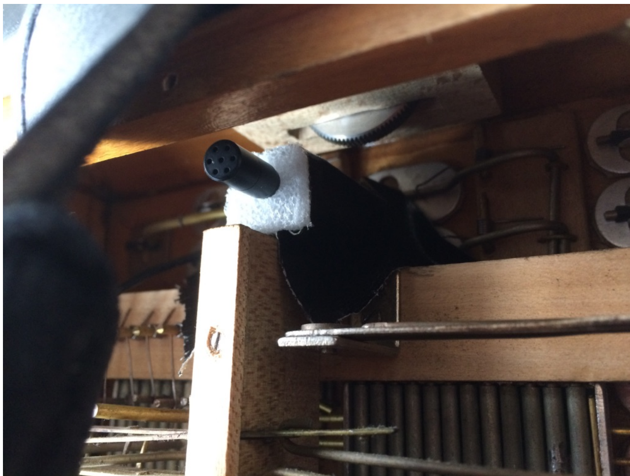
Obr. 11 Sennheiser ME 2-II nahoře na basové části nástroje, fotografie
