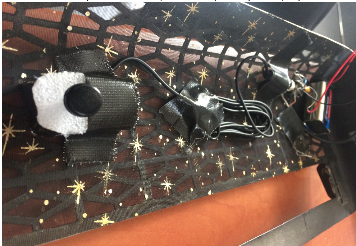
Obr. 12 Sennheiser ME 4-N na krytu diskantové části, fotografie
