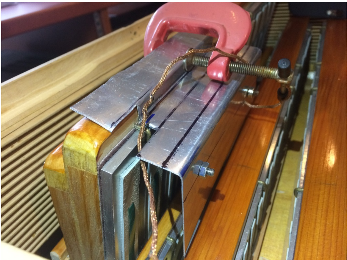
Obr. 18 Elektromagnetický snímač Tesla uvnitř basové části nástroje, fotografie
