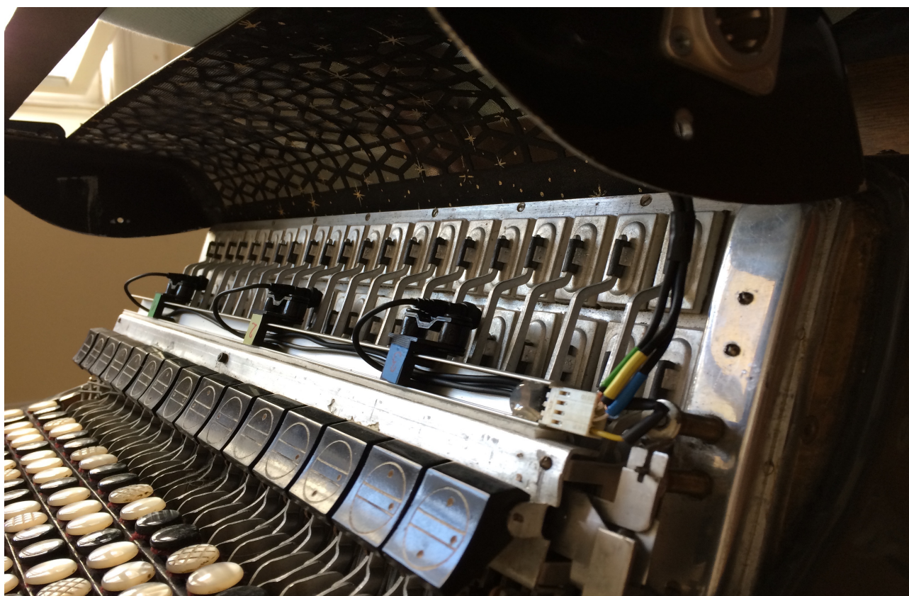
Obr. 30 Mikrofonní systém na diskantové části nástroje
