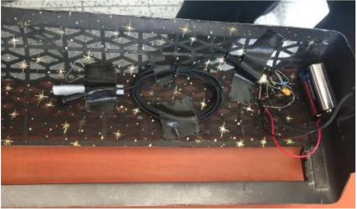
Obr. 8 Sennheiser ME 2-II na krytu diskantové části, fotografie
