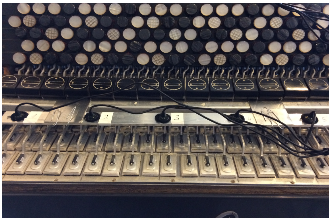
Obr. 23 Pět kardioidních mikrofonů Sennheiser ME 4-N na diskantové části, fotografie
