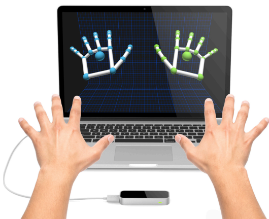
obr. 4: Leap Motion – komerčně rozšířený ovládací systém založený na detekci jednotlivých bodů (a jejich spojů) lidských rukou v prostoru.
