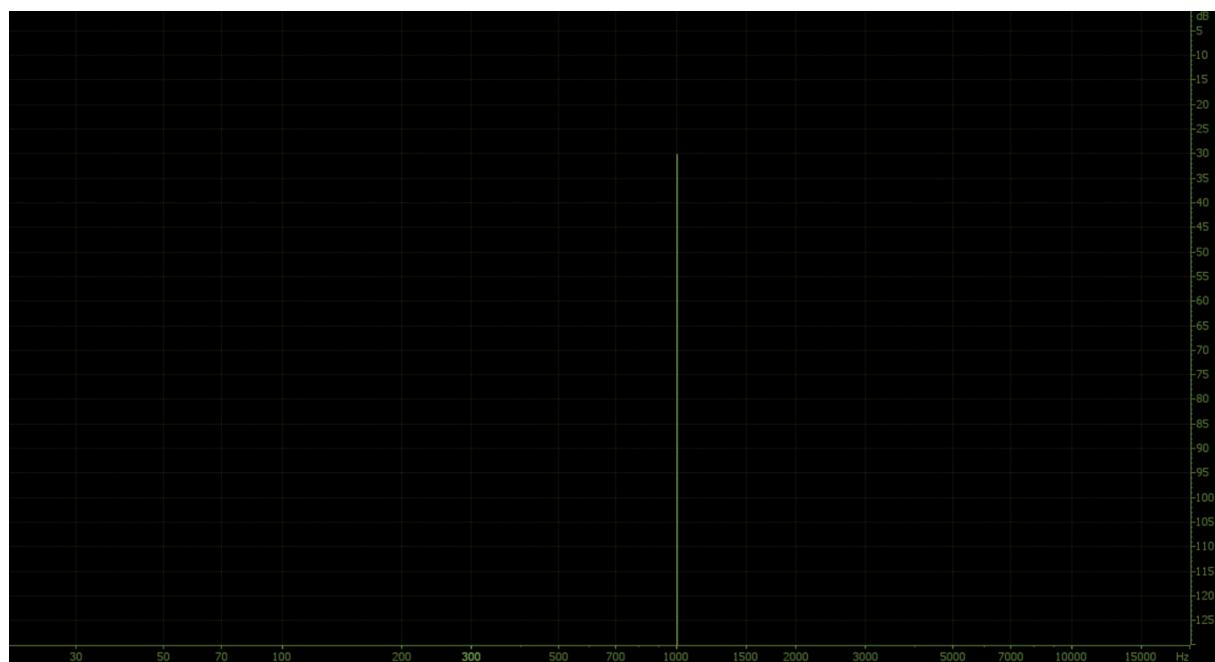
Obrázek 3.6.1: Spektrum sinového signálu o frekvencii  $1\text{ kHz}$
