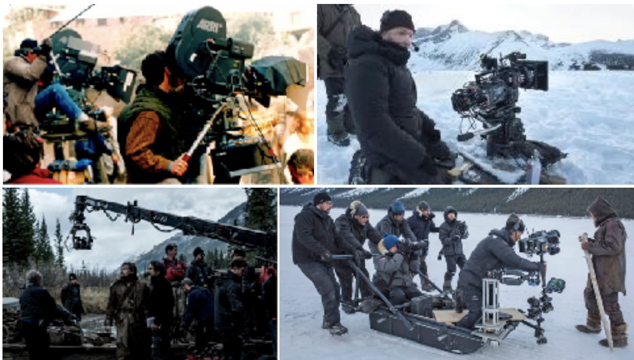
Filmová kamera Arriflex 765 a Emmanuel Lubezki s digitální ARRI ALEXA 65mm. Realizace pohybu kamery z jeřábu a sněžných saní.
