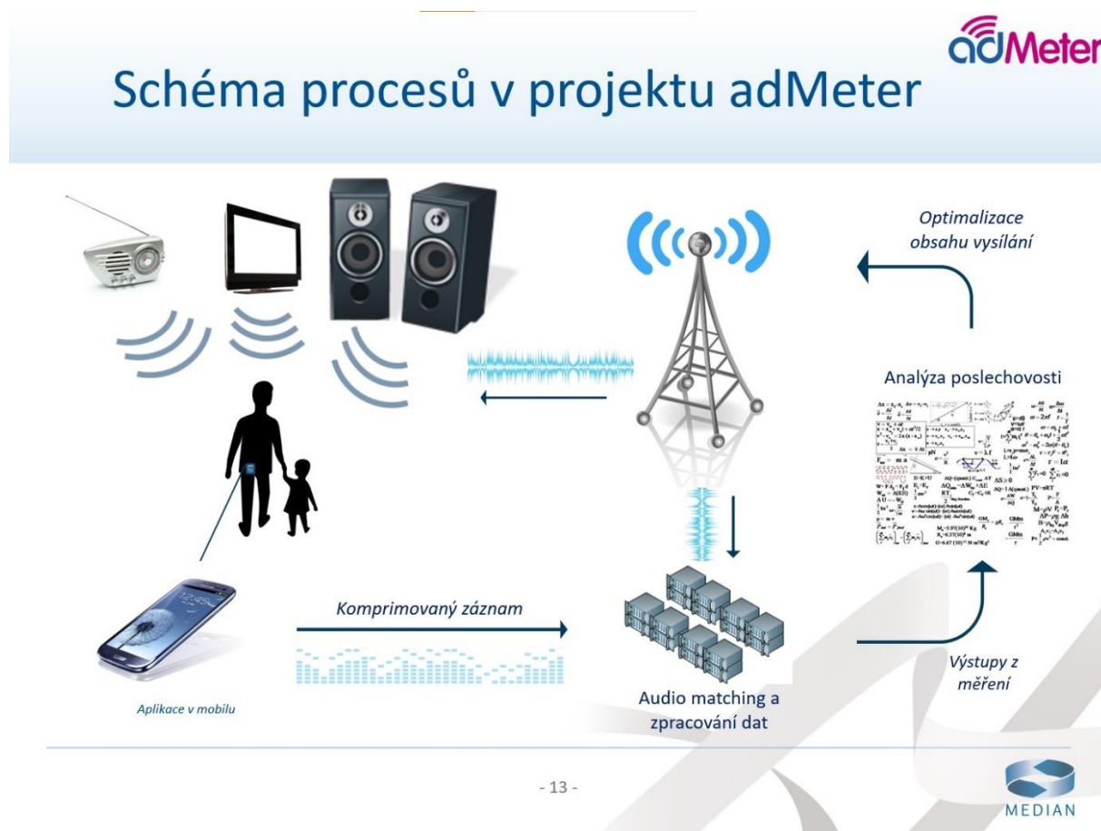
Obrázek 1 Schéma procesu elektronického měření adMeter, zdroj: Prezentace společnosti Median, s.r.o., listopad 2013
