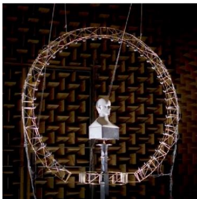
Obrázek 19 Měření HRTF v bezdozvukové komoře 206
