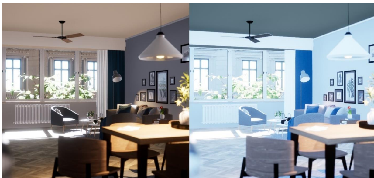
obr. 9.1-2 Porovnání scény zasvícené pomocí dynamického osvětlení s různým nastavením zdroje Skylight. Zdroj Skylight vytváří cubemap z prostoru pokoje (vlevo). Zdroj Skylight vytváří cubemap z atmosféry v okolí domu (vpravo). Unreal Engine 4.25.4, (vlastní tvorba, (Engine 2019))
