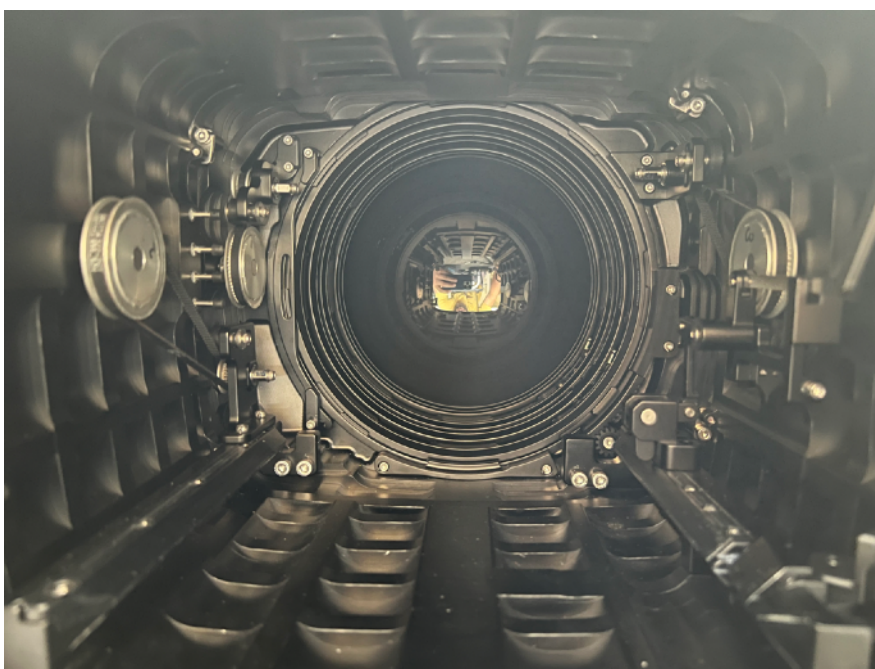
Obr. 19: Žebrování uvnitř Nauticamu.
