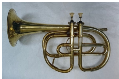
Obrázek 1: Trumpeta osazena Stölzlovým ventilem.
