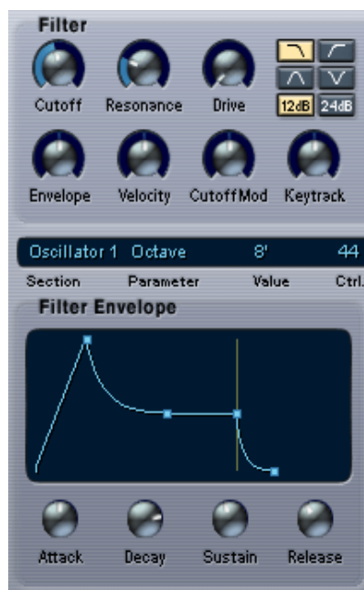
Obr. 3.4 Příklad uspořádání panelu napětově řízeného filtru (VCF)
