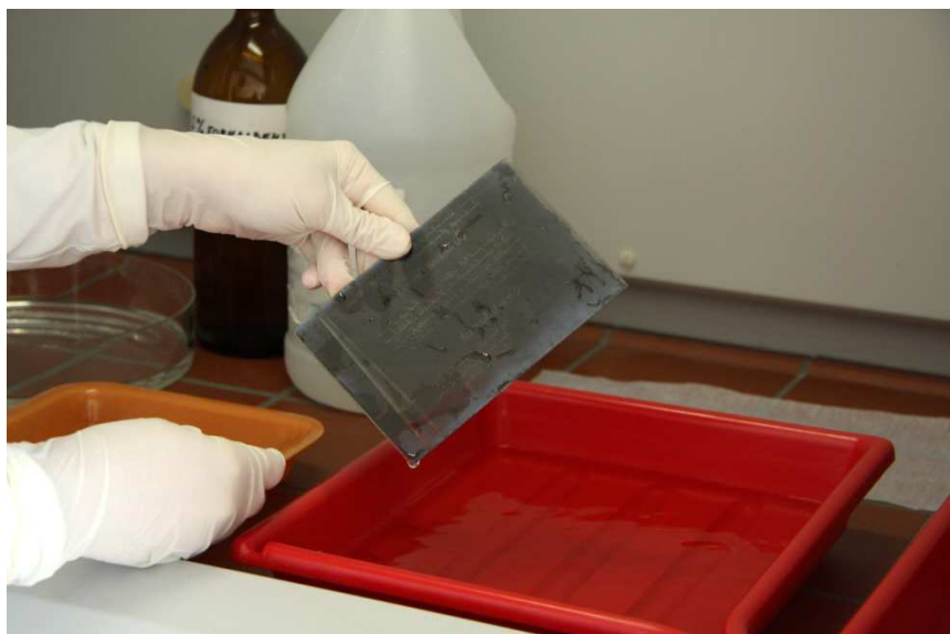
Obr. 75 Promytí negativu v destilované nebo deionizované vodě
