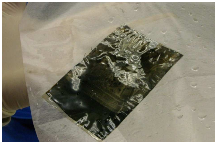
Obr. 78 Transport citlivé vrstvy na netkané textilii
