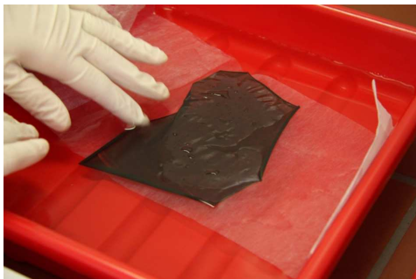
Obr. 79 Promývání uvolněné citlivé vrstvy v destilované nebo deionizované vodě. Pro snadnější manipulaci je použita netkaná textilie
