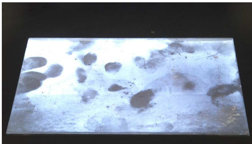
Obr. 13 Otisky prstů na citlivé vrstvě
