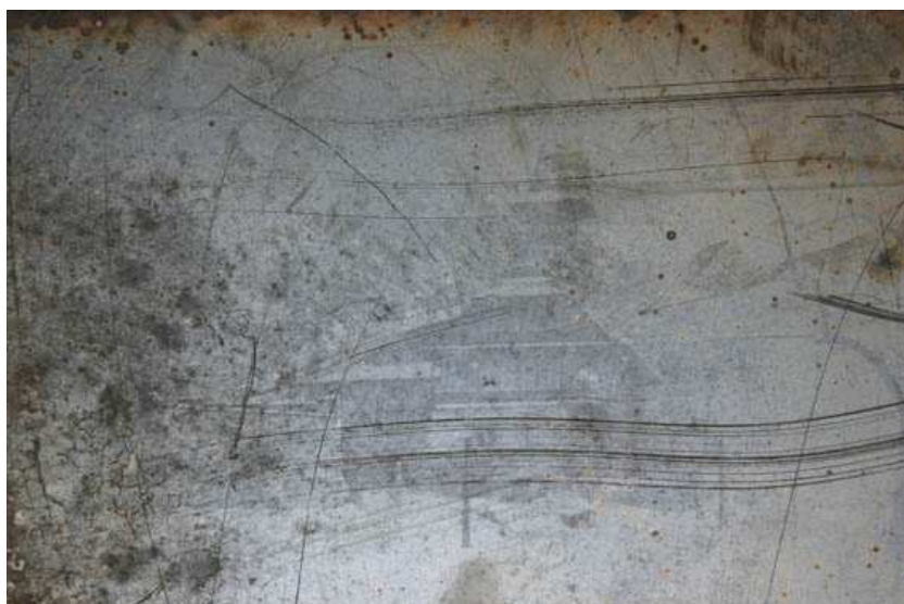
Obr. 14 Vrypy na citlivé vrstvě, tvorba stříbrného zrcátka
