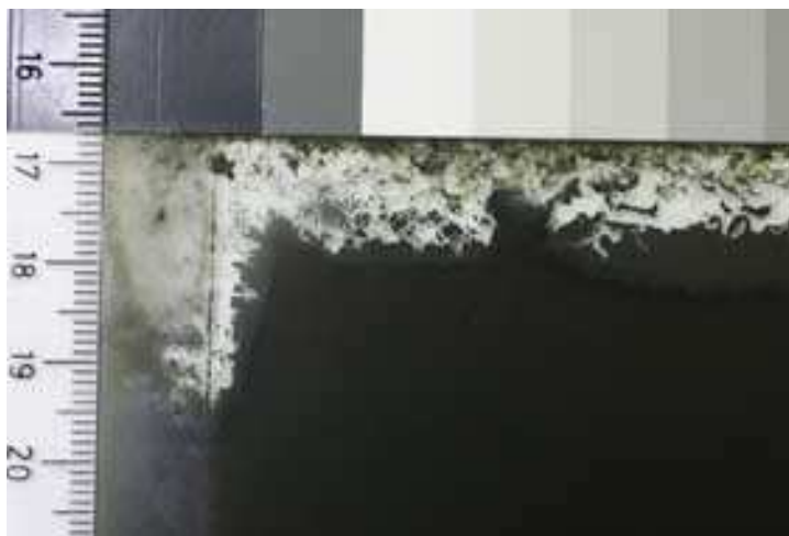
Obr. 44 Zbytky fragmentů citlivé vrstvy
