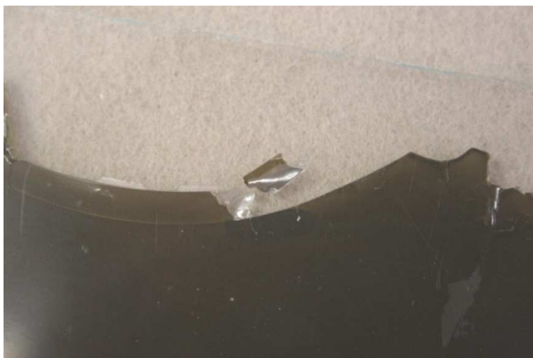
Obr. 54 Ulomený fragment skleněné podložky s citlivou vrstvou
