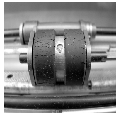
Abb. 7, extrem stark gealterte Gummirollen
