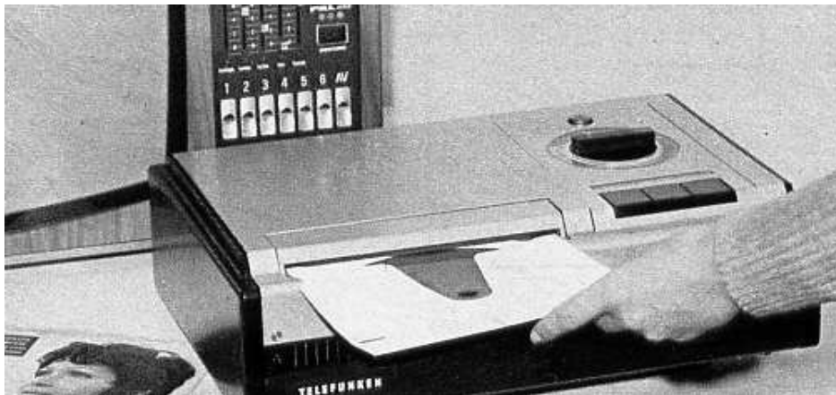
Abb1, Bildplatte, Bildplattenspieler der ersten Serie Aufn. Telefunken
