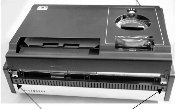
Abb. 3, Öffnen des Deckels durch Drücken beider Entriegelungen
