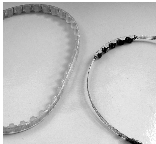
Abb. 9, Vergleich: neuer (links) und zerfallener Zahnriemen (rechts)
