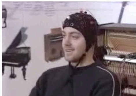
Obr. 73 Myslí ovládaný mechanický klavír: senzor, snímající elektromagnetické podněty mozku, posílá informace počítači, ten je zpracovává a posílá druhému počítači, který informace převádí na povely MIDI a posílá do mechanického klavíru
