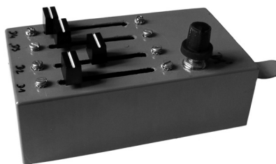
Obr. 61 Pět potenciometrů pro ovládání hlasitosti difuzérů
