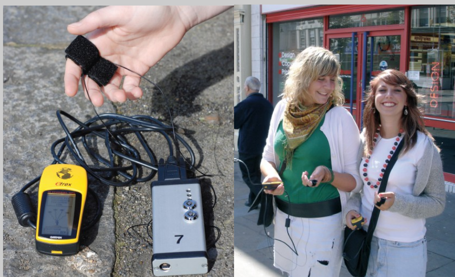
Obr. 3.17: Zařízení pro biomapping Christiana Nolda sestává z GPS lokátoru, snímače odporu kůže připevněného k prstům a záznamníku.
