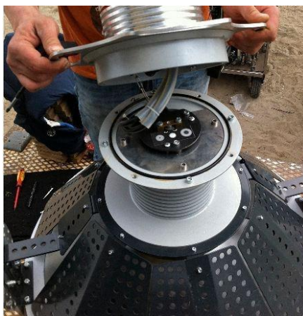
Obrázek 7: Sejmutí zadního krytu reflektoru RLS-70 před jeho kalibrací
