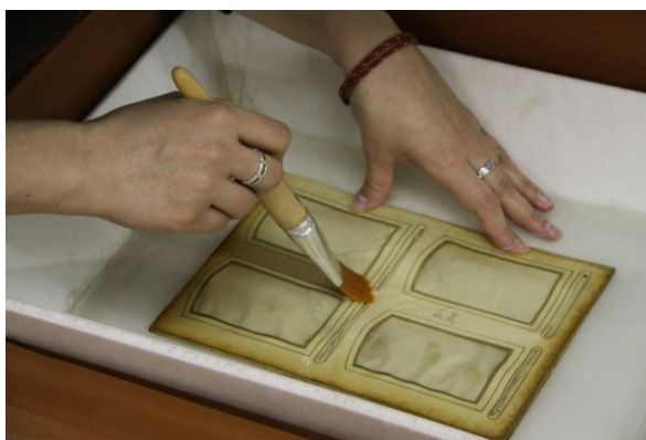
Obrázek 45: Ukázka mokrého čištění folií ve vodní lázni
