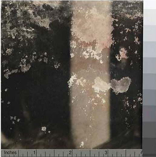
Obr. č. 17. Napadení citlivé vrstvy plísní
