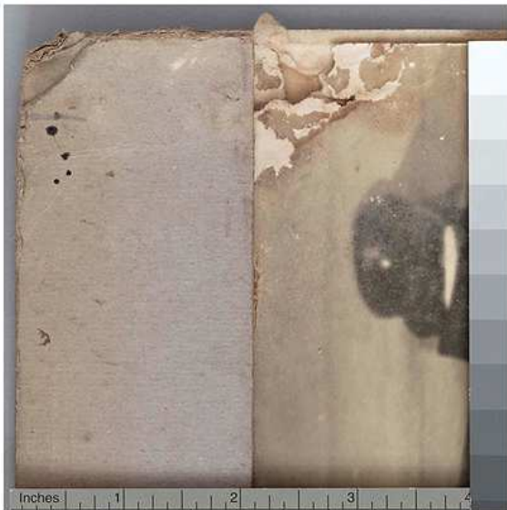
Obr. č. 11. Nedostatečná adheze pozitivu k druhotné podložce
